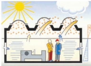
Natürliche Lüftung durch Dachlichtelemente
