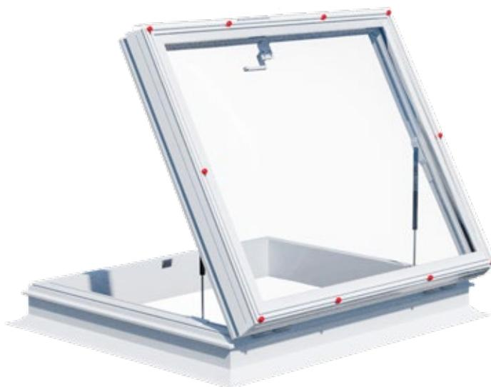
Abbildung: JET-LICHTKUPPEL-GLAS montiert auf steilem PVC-AK-16 mit mechanischem Dachausstiegsbeschlag inkl. Tandem-Gasdruckfedern (1 x arretierbar), Handgriffe (innen und außen), sowie Verriegelung; Öffnungswinkel: max. 60°
