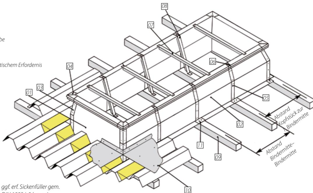
ggf. erf. Sickenfüller gem. DIN 18234-3 bauseits
