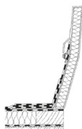
JET-GFK-RAK für RWA mit optionaler GFK-Schürze (Überhangstreifen)
