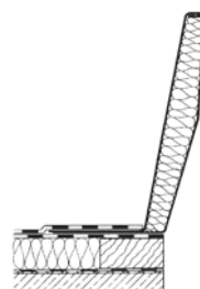
JET-Stahl-Alu-Verbund-AK für RWA Typ RAK, 30 cm hoch Anschlussbeispiel: bituminöse Dachbahnen
