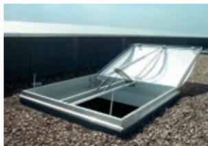
JET-VARIO-Lichtklappe mit RWA-Beschlag und E-Motoren nach RWA-Auslösung in Endlagenstellung
